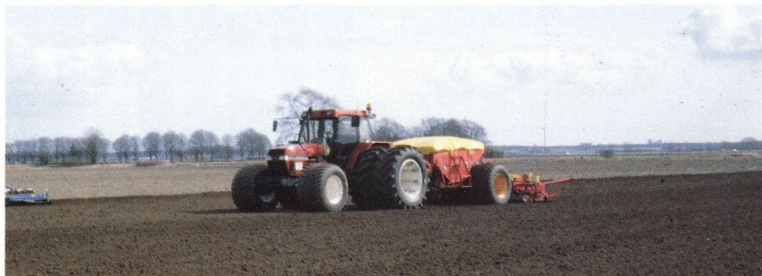
Vårplöjning med tiltpackare. Såbäddsberedning, gödsling och sådd med Överum Tive Combi-Jet utrustad med Twin 800/40-26.5 med 0,3 bars lufttryck. Combi-Jet-ekipaget gör vårbruket klart direkt efter tiltpackaren i en jämnt återpackad såbädd utan spår.
