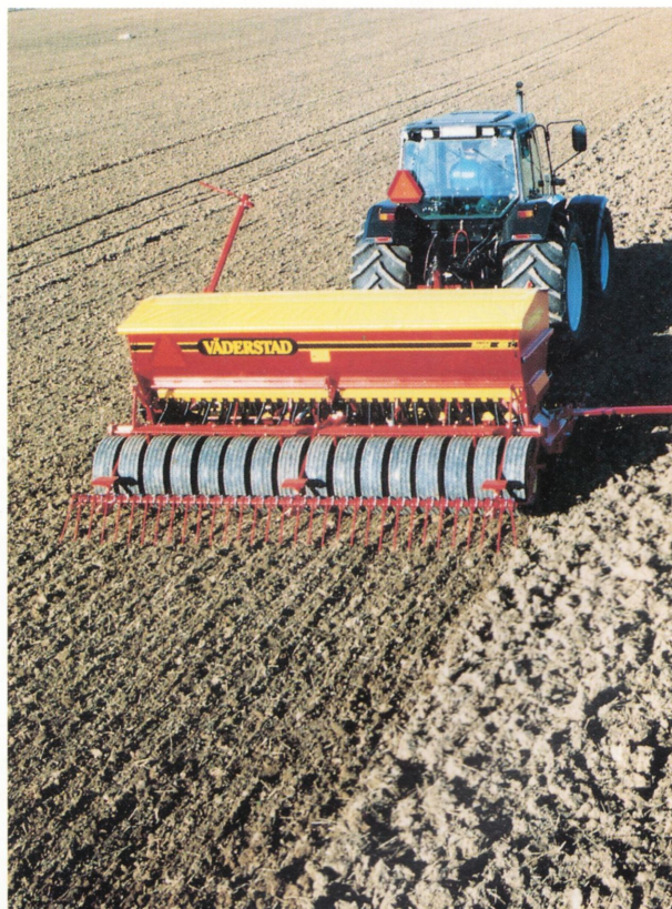
Rapid 400 med Twin på lerjord utan plöjning i Sverige. Obs! Maskinens förmåga att själv skapa såbruk.
