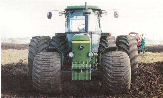
Traktorn sett framifrån med breda framdäck då framaxelvikten ej läggs över på mellanpackaren
