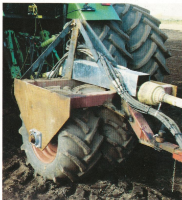
Mellanpackare med traktormönstrade däck monterad bak på traktorn.
