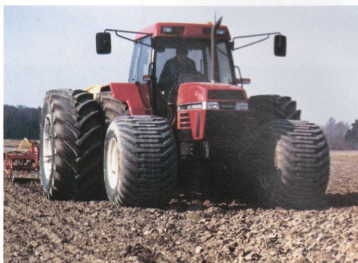
Tidig vårsådd med Combi-Jet med sladdplanka på mellanlera som var plöjd och tillämnad på hösten. Hela vårbruket görs i en överfart. Med bra däckutrustning tål leran en överfart redan när översta centimetramna torkat upp. Däckutrustning dubbla Twin 650/60-38 och 800/40-26.5
